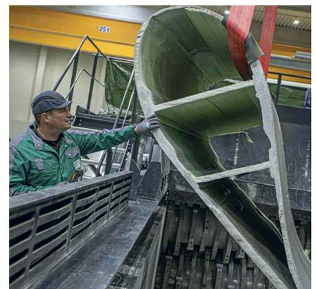
Ausgediente Rotorblätter von Windrädern werden in einer Anlage in Sachsen-Anhalt aufbereitet, um die enthaltenen Wertstoffe erneut zu nutzen.
